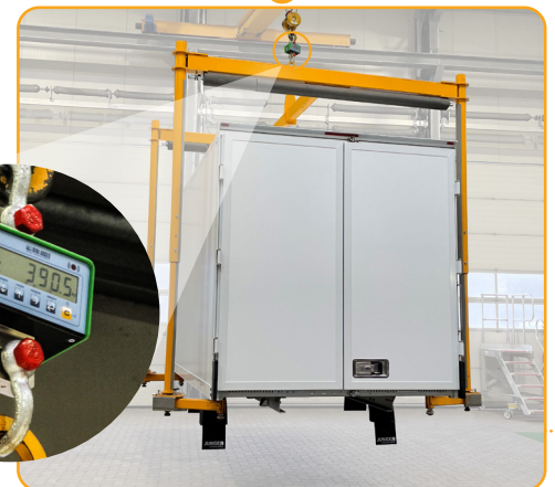
Aufbaueigengewicht (Länge 4.400 mm) inkl. Unterbau und Hecktüren
